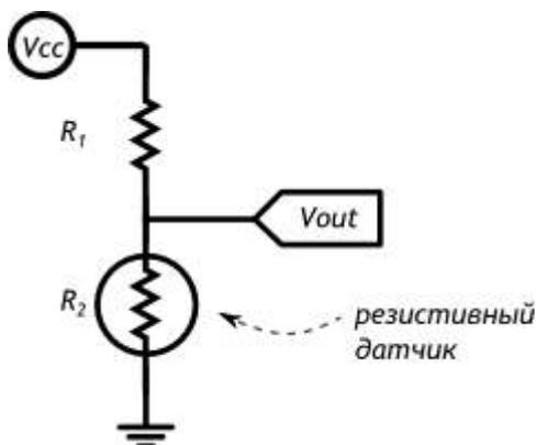
Микроконтроллер умеет измерять напряжение. Таким образом, мы можем использовать свойства делителя напряжения для получения показаний от сенсора.
