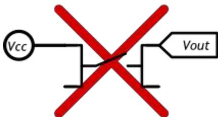
Пока кнопка нажата, выходное напряжение  $V_{out} = V_{cc}$ , но пока она отпущена,  $V_{out} \neq 0$ . Кнопка и провода в этом случае работают как антенна, и  $V_{out}$  будет «шуметь», принимая случайные значения «из воздуха».
