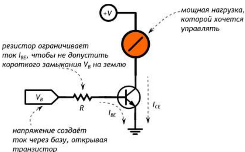
Транзистор усиливает максимально допустимый ток в  $h_{fe}$  раз:
