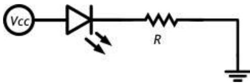
Собственное сопротивление светодиода после насыщения очень мало, и без резистора, ограничивающего ток через светодиод, он перегорит
