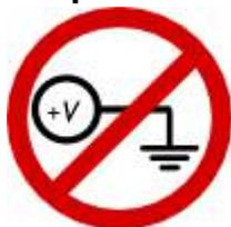
Соединение плюса с минусом напрямую, по закону Ома, приводит к очень большому току, следовательно, к очень большой мощности нагрева, что в итоге приводит к возгоранию.
