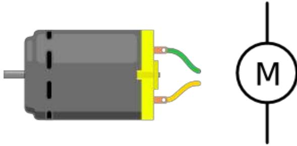
Самый простой вид мотора – коллекторный. При подаче напряжения в одном направлении вал крутится по часовой стрелке, в обратном направлении – против часовой
