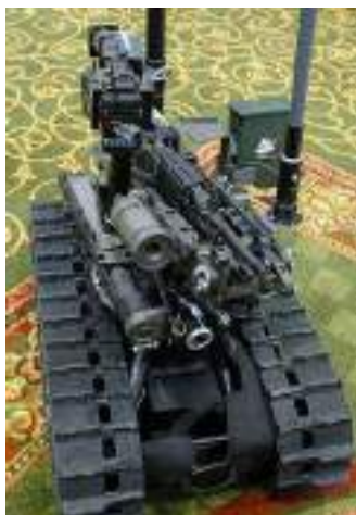
Рисунок 2: TALON - это гусеничный манипулятор, предназначенный для установления прямого контакта с противником в бою.
