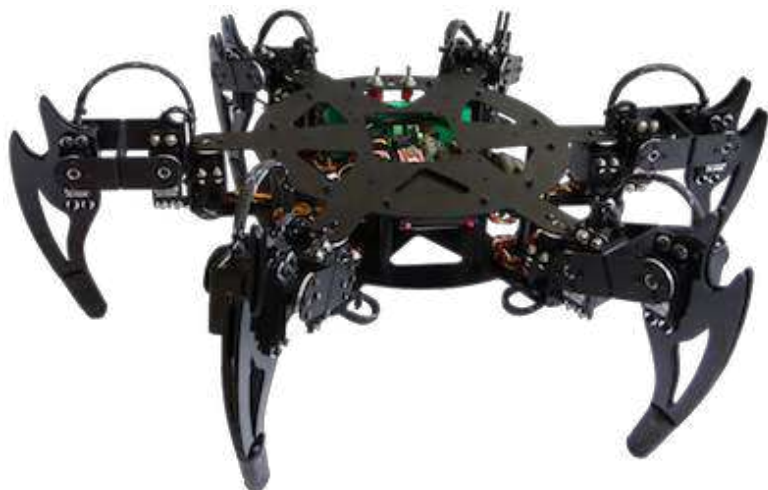
Рисунок 1. Робот, напоминающий шестиногое насекомое - Hexarod.
