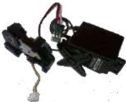
Рисунок 5: Типовой серводвигатель справа и разобранный серводвигатель слева.
