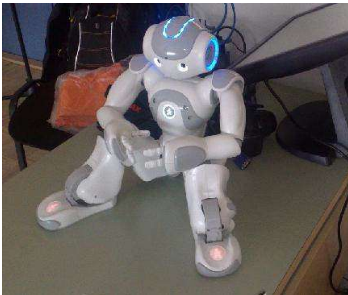
Рисунок 2: Гуманоидный робот Nao, относящийся ко второму поколению. Nao - программируемый робот-гуманоид высотой 58 см и весом 4,3 кг. Nao доступен для исследовательских и образовательных целей с 2008 года.
