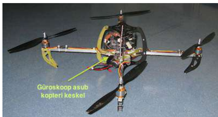
Рисунок 5: Расположение гироскопа на четырехкрылом самолете.
